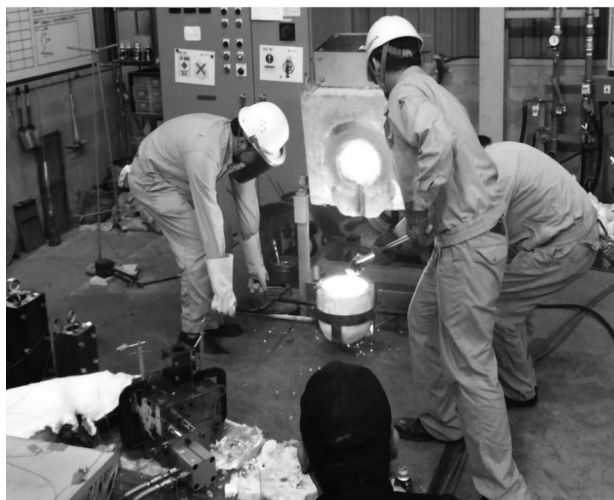
図 11 フリー窒素・スリーブ法による半凝固鑄造
