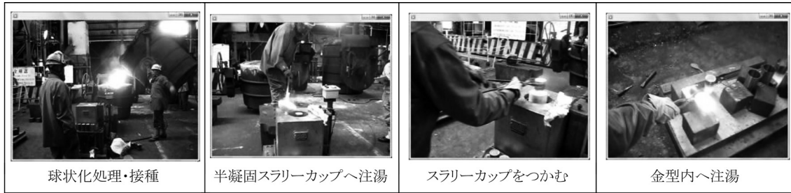
図7 フリー窒素・ナノキャスト法による半凝固鑄造
